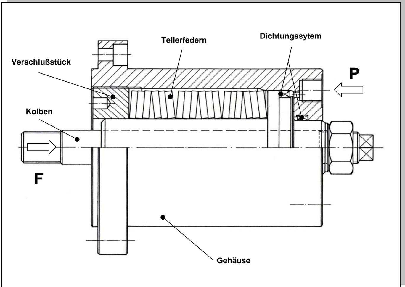
Der Federspannzylinder wird mittels angeschlossener Hydraulikeinheit mit dem hydraulischen Lösedruck beaufschlagt. Durch diesen Vorgang kann der Federspannzylinder in die vorgesehene Position montiert werden. Danach wird der Federspannzylinder hydraulisch entlastet. Die eingebauten Tellerfedern verspannen das zu befestigende Maschinenteil.
