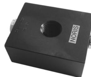
Der Druckaufbau wird mittels fest angeschlossener Ölpumpe oder Hydraulikaggregat eingeleitet. Das Medium fließt in die planseitig vorhandene Ringnut und bewegt die Nutringdichtung und den Ringkolben. Der Systemdruck in der Spannmutter lässt sich am Manometer des Druckerzeuger präzise ablesen. Der Druckabbau erfolgt direkt über das angeschlossene Druckerzeugersystem. Der Ringkolben mit der Spannmutter wird zur Gegenfläche gedrückt. Das Medium fließt zurück in das Druckerzeugersystem.
